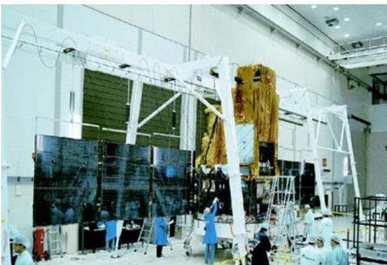
Abbildung 4 Aufhängung während eines Solar Array Deployment Test
