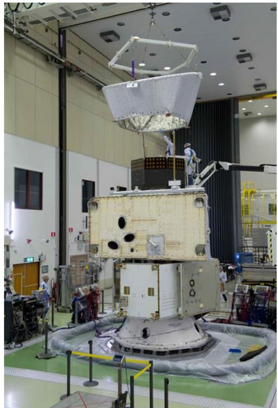
Abbildung 2 Shaker und Satellit bei der Testvorbereitung
